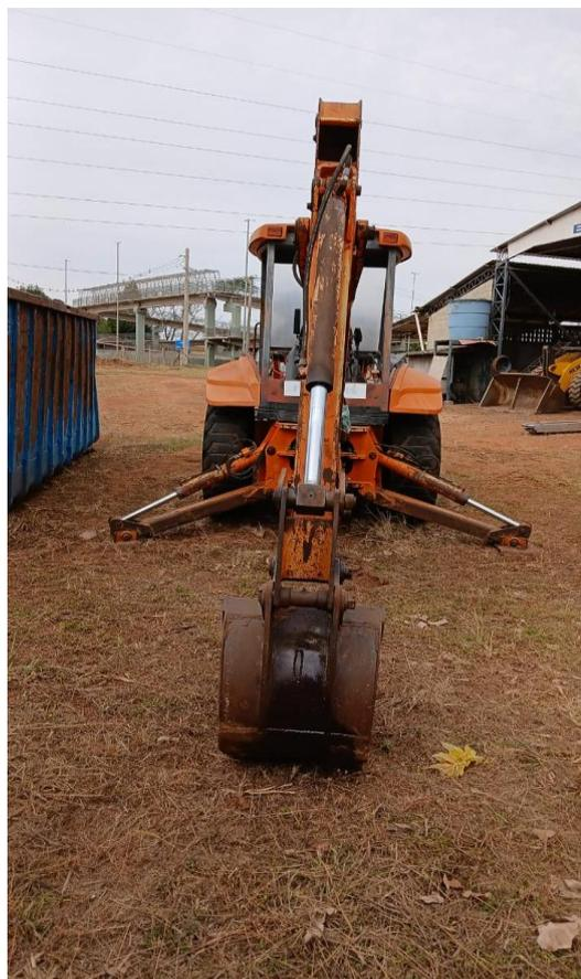
**Comentários:** Retroescavadeira FIATALLIS, modelo FB 80.2, ano de fabricação 2000, necessita de uma revisão nos seguintes componentes: cilindros de elevação do H, todos os cilindros do retro e estabilizadores, embuchamento do retro e estabilizadores completo, trocar munhões e embuchamento do eixo dianteiro, sistema hidráulico, transmissão, freio traseiro de serviço, freio estacionário e sistema elétrico.
